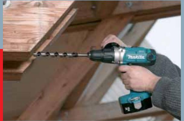
Das Drehmoment entscheidet, nicht die Geschwindigkeit. Der erste Gang ist speziell für schwerste Arbeiten ausgelegt. 80 Nm bei den 18 V Modellen im harten Schraubfall.
